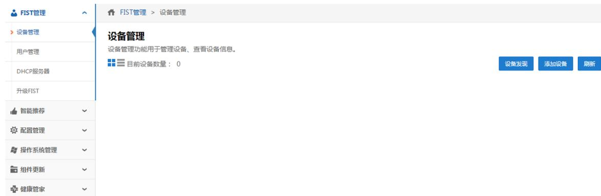
b. 如 图 2-11 所示，单击<添加设备>按钮，选择<单台添加>，在弹出对话框的设备类型下拉框中选择HDM，然后输入待更新BIOS的服务器的HDM信息（请确保输入的HDM用户的网络权限为“Administrator”，否则不支持进行BIOS更新操作）。单击<确定>按钮完成添加。
