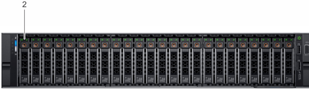
图 3: 24 x 2.5 英寸系统的前视图
