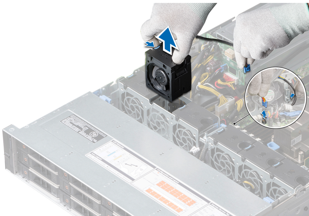
图 34: 卸下冷却风扇
