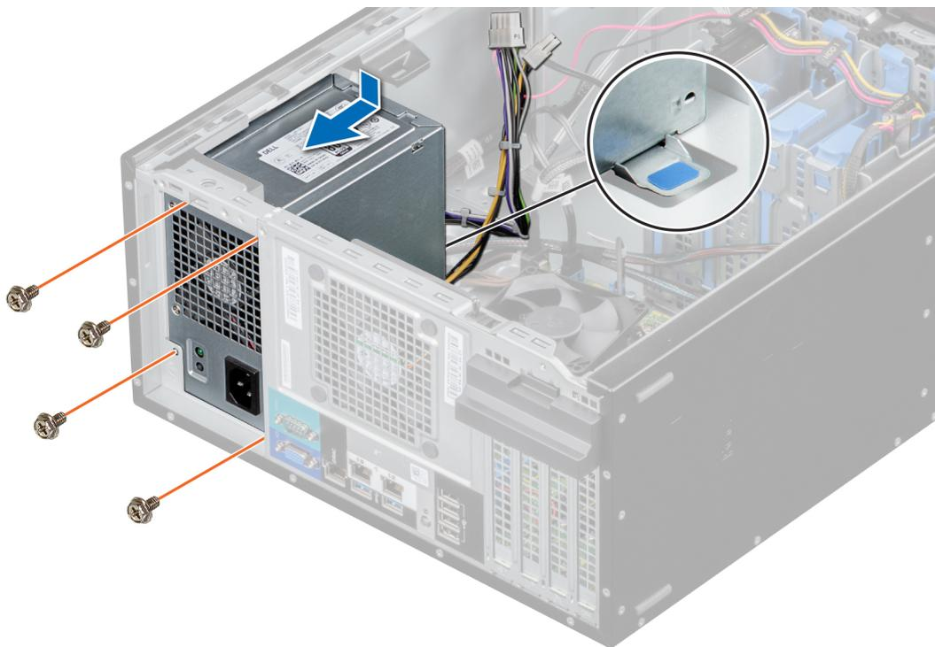
图 45: 安装 PSU
