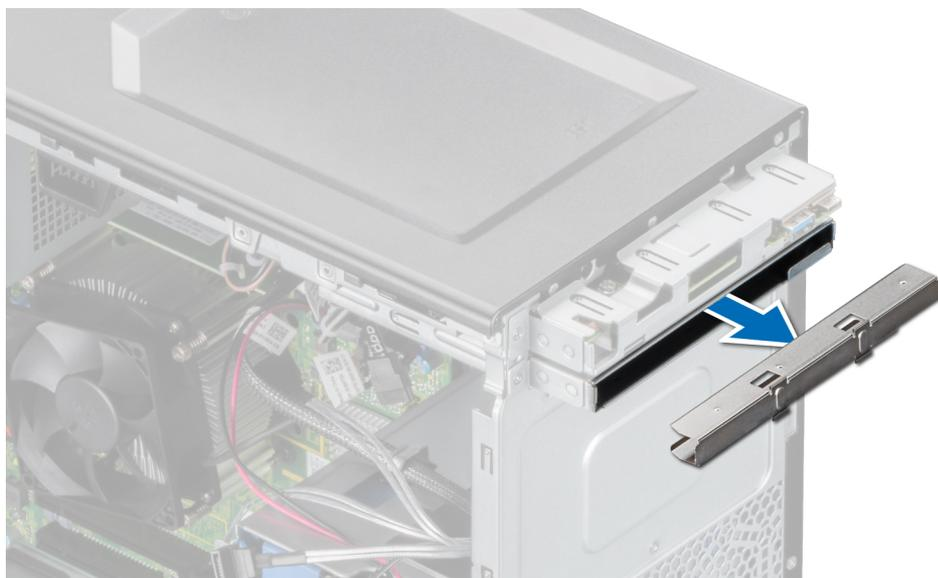
图 18: 从光盘驱动器固定框架中卸下光盘驱动器填充挡片
