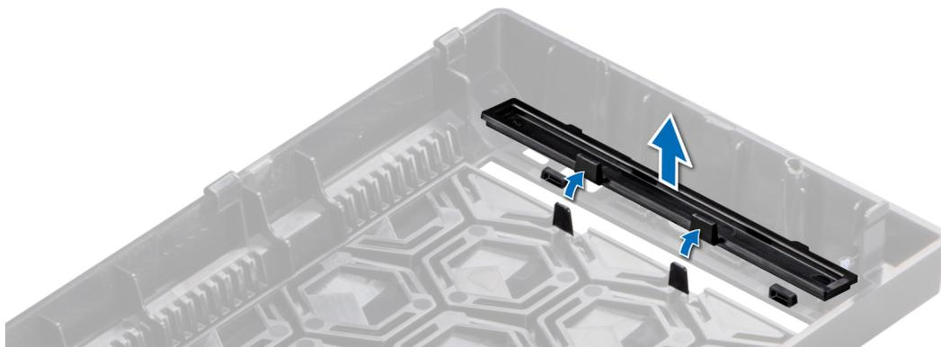
图 17: 从前挡板卸下光盘驱动器填充挡片
