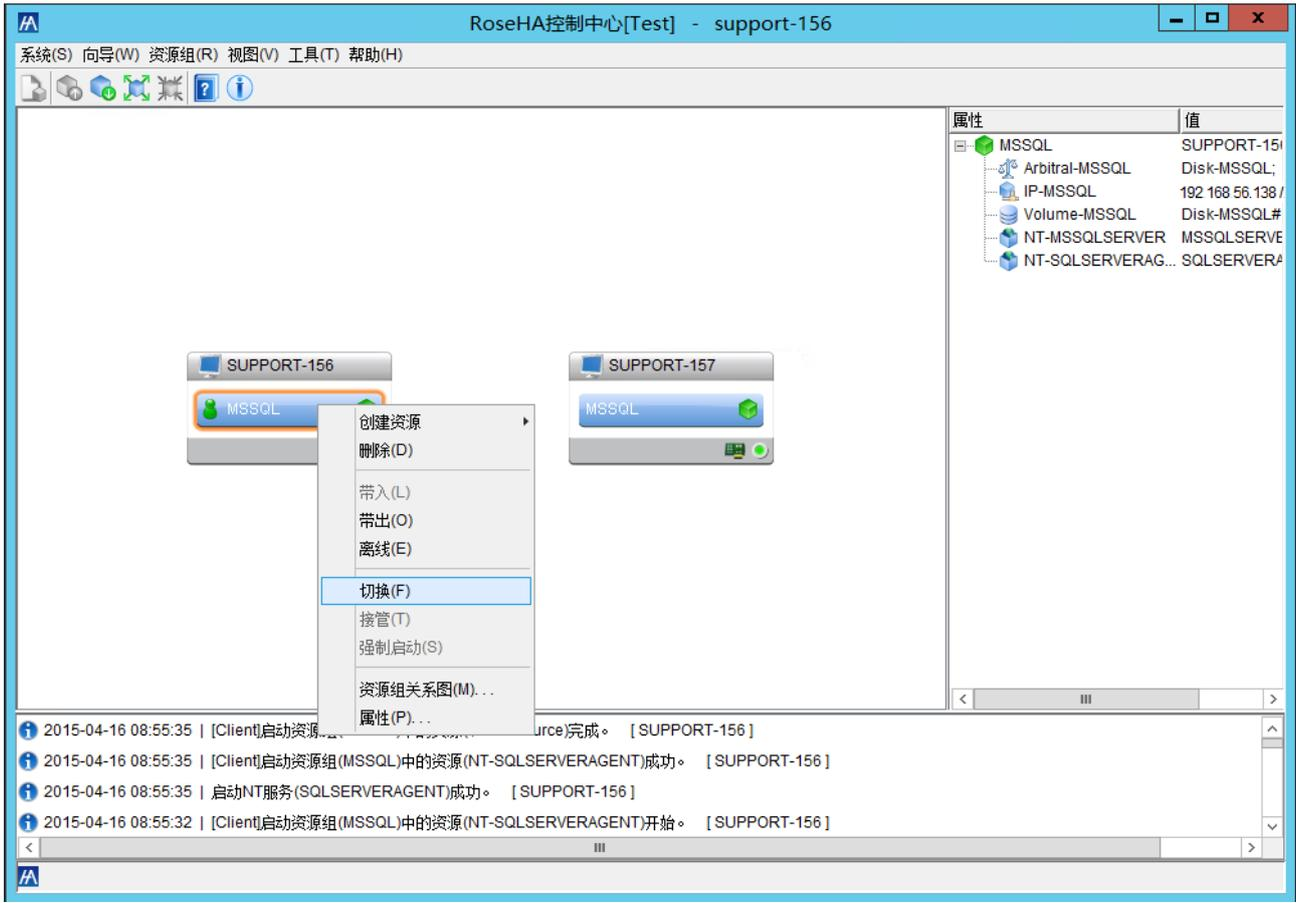
选择切换的备用主机后，点击“**确认**”，将资源组切换到备用主机，资源将在备用主机启动。
