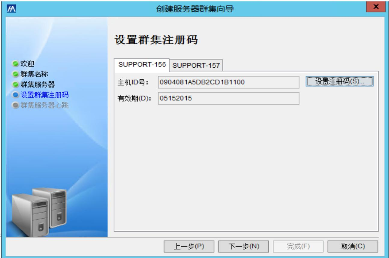
拷贝注册码文件至服务器（注册码文件名的格式：**\*\_主机 ID 号\_\*.lic**），点击“**设置注册码**”按钮，对应主机 ID 号打开相应的注册码文件。2 台服务器的注册码文件加载后，检查“有效期”是否显示使用期限（永久注册码为 8 个 9 “99999999”；临时注册码为截止有效期“月日年”）。点击“**下一步**”，进入创建群集服务器心跳页面。
