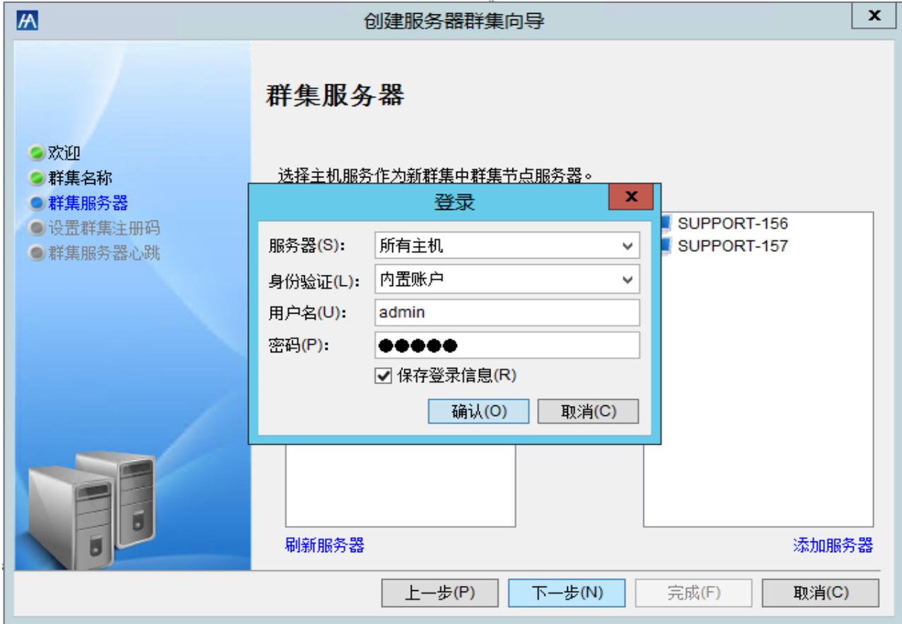
5) 如果是初次安装、配置 RoseHA，登录两台服务器，进入群集服务器序列号设置页面。分别复制两台服务器的主机 ID 号，并将主机 ID 号发给软件供应商，获取合法的注册码文件。
