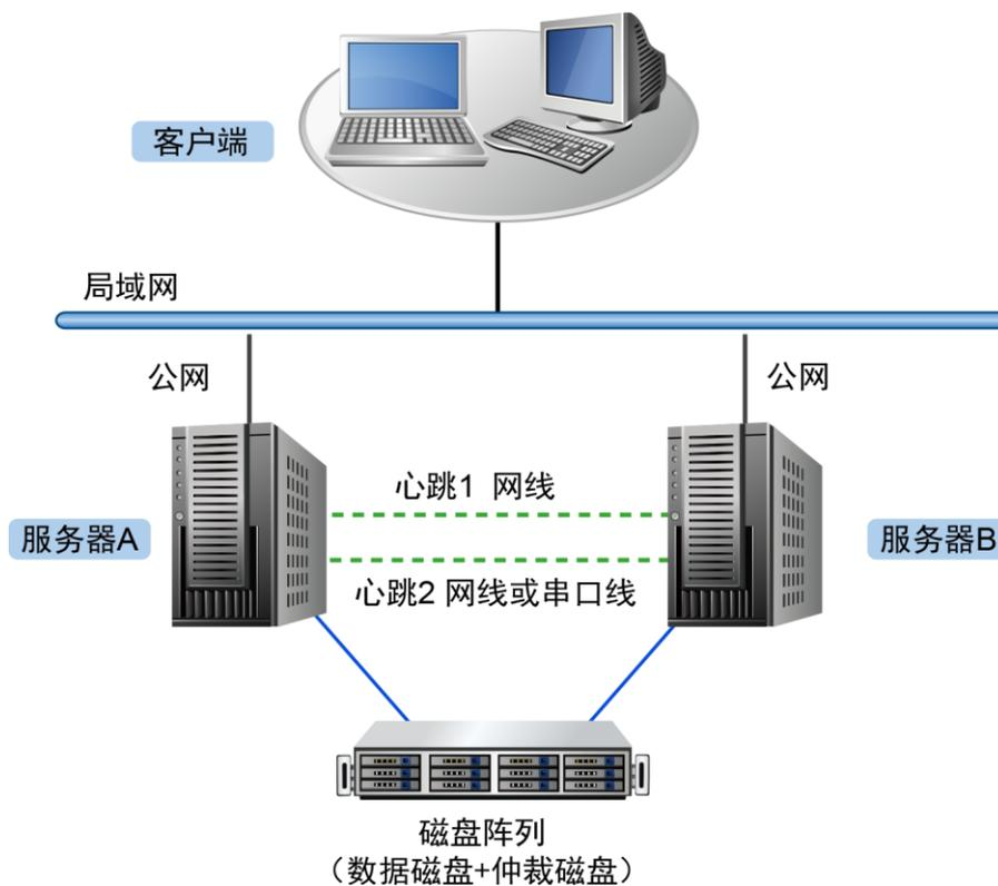
如上图所示，RoseHA 集群硬件结构主要包括两台硬件服务器 A 和 B，以及一台磁盘阵列。
