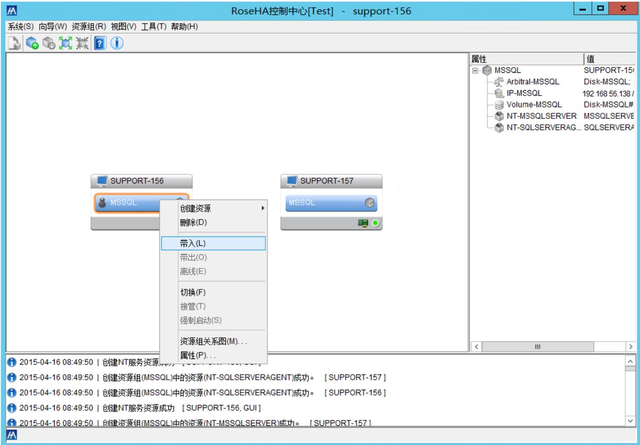
在该视图中，选中资源组可以在右边的列表中看到所配置资源的信息；选中服务器，可以在右边的列表中看到配置的网卡组、磁盘组以及服务器之间的心跳信息。
